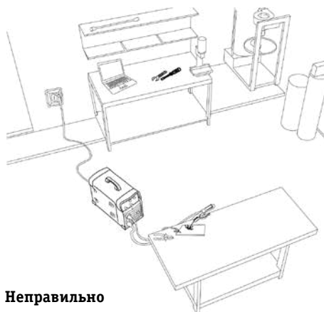
Рис. 8.4. Подключение оборудования к электрической сети.
