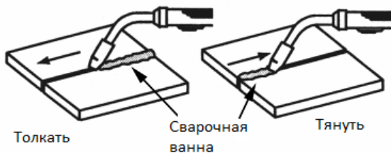
Рисунок 19. Направление движения горелки
