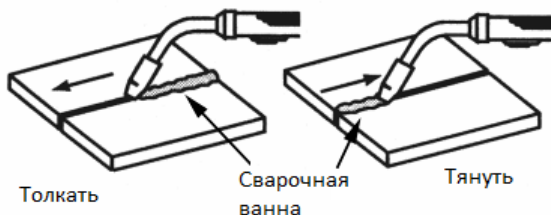
Рисунок 19. Направление движения горелки
