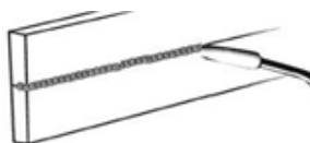
Рисунок 22. Сварка в горизонтальном положении
