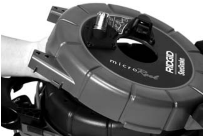
Рис. 5 – Осторожно откройте барабан, чтобы уложить кабель
