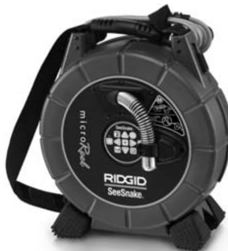
Рис. 7 – Правильно уложенная головка видеокамеры
