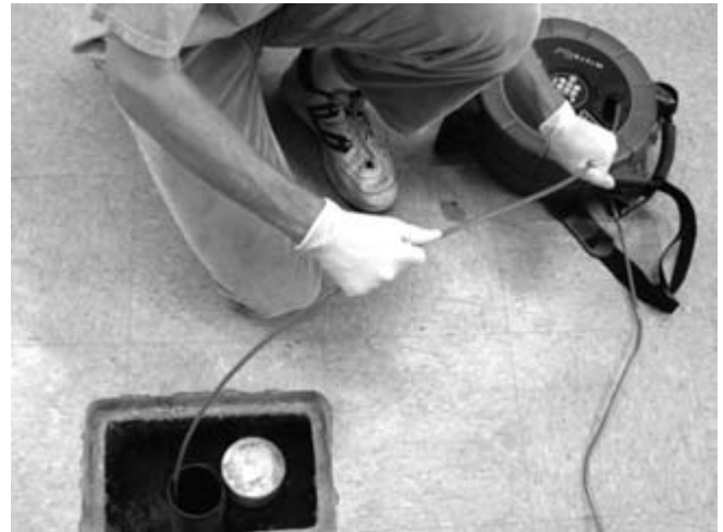
Рис. 28 – Надлежащий метод проталкивания кабеля назад в барабан
