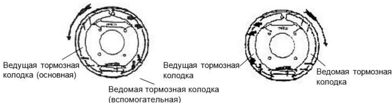
Рисунок 2-5: Действие при движении вперед      Рисунок 2-6: Действие при движении назад
