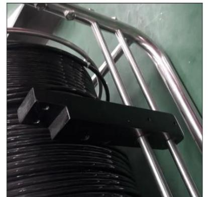
(8)(9) Подключите кабель к счётчику метража.
