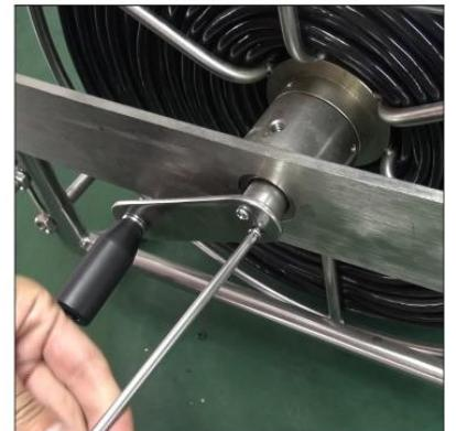
(5)(6)(7) Сборка счётчика метража.
