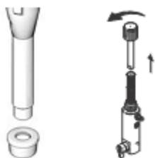
10. Заполните уплотнительную гайку горловины TSL, чтобы предотвратить преждевременный износ уплотнения. Делайте это перед каждым распылением.
