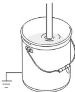
10. Снова нажмите на спусковой механизм, направив краскораспылитель в ведро с промывочной жидкостью, пока из него не пойдет материал.
