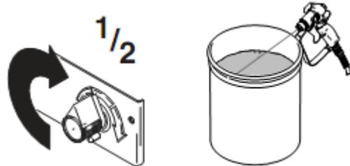
4. Перенесите краскораспылитель в пустое ведро, прижмите его к стенке ведра, нажмите на спусковой механизм, чтобы тщательно промыть систему. Отпустите спусковой механизм и активируйте предохранитель спускового механизма.
