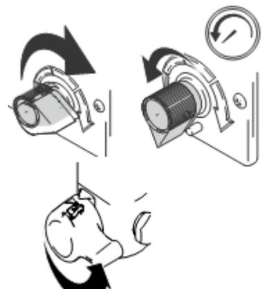
7. Снимите предохранитель краскораспылителя.
