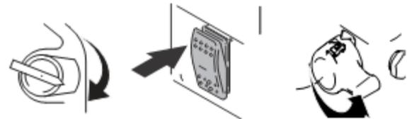
3. Переведите регулятор давления в среднее положение. Прижмите краскораспылитель к стенке ведра с материалом. Снимите предохранитель спускового механизма. Увеличивайте давление, пока двигатель не приведет в действие насос. Нажимайте на спусковой механизм краскораспылителя, пока из него не пойдет промывочная жидкость.
