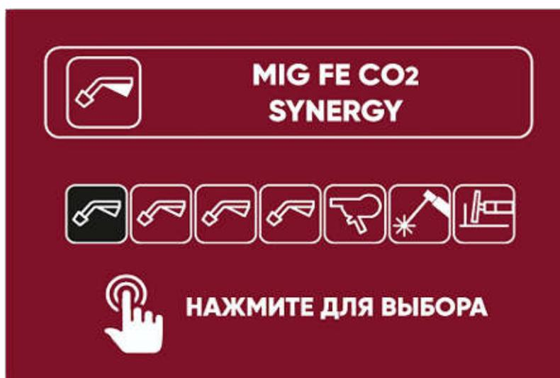
5.1.5.2 На многофункциональном цифровом дисплее отобразятся два значения. Слева находится заданное сварочное напряжение, справа – заданная скорость подачи проволоки. Эти значения регулируются поворотом правого регулятора (3). Благодаря синергетическому , напряжение и цепь будут регулироваться синхронно.
