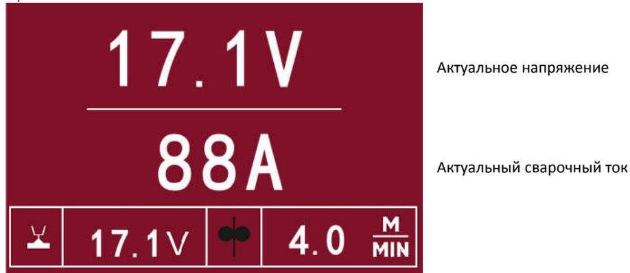
5.1.5.7 Функция 2Т / 4Т: нажмите правую кнопку (4), переключатель выбора 2Т / 4Т для перехода между режимами 2Т и 4Т. 4Т означает, что клавиша горелки нажимается один раз, чтобы начать сварку и снова нажимается, чтобы остановиться. Это удобно для длинных сварных соединений. 2Т, клавиша должна быть нажата и удерживаться во время сварки.
