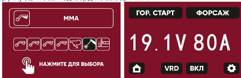
На экране отобразится заданный сварочный ток MMA. Его можно отрегулировать, вращая регулятор параметров сварки (3).
