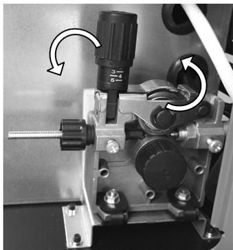
4.1.2.2 Проверьте, что прижимной ролик (16) соответствует выбранному типу и размеру проволоки.
