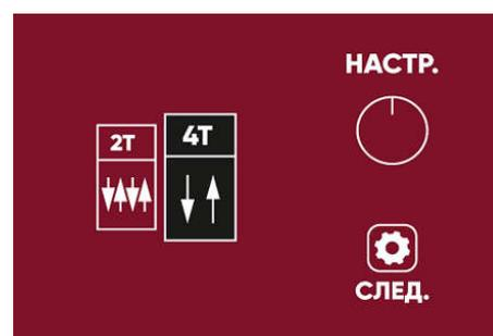
5.1.5.8 Функция протяжки проволоки : снова нажмите правую кнопку (4), чтобы войти в режим протяжки проволоки, поверните правую ручку (3), чтобы выбрать ON / OFF
